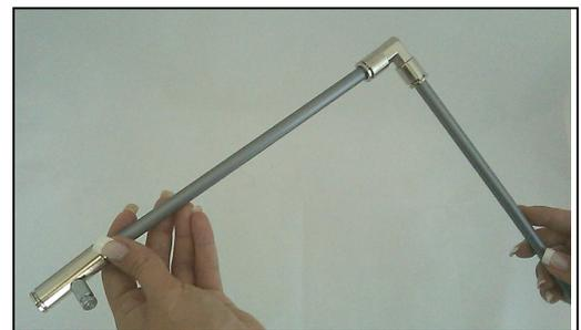
**Rauch HD Hochdruck Leitungen sind für bis zu 100 Bar Druck** geeignet und lassen sich mit einer Trennschere in beliebige Längen kürzen. Düsen können somit frei nach Belieben angeordnet werden
