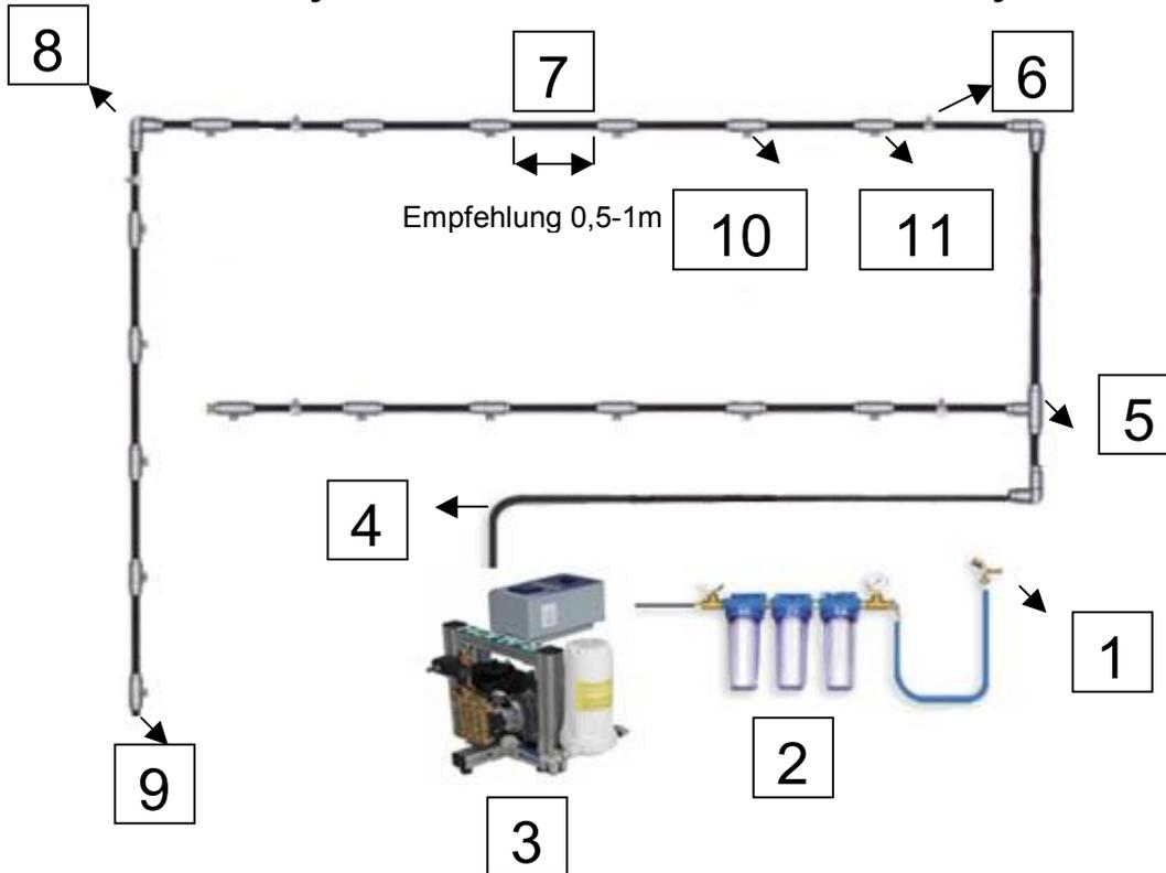
1. Wasseranschluß Max. 3-4 Bar
